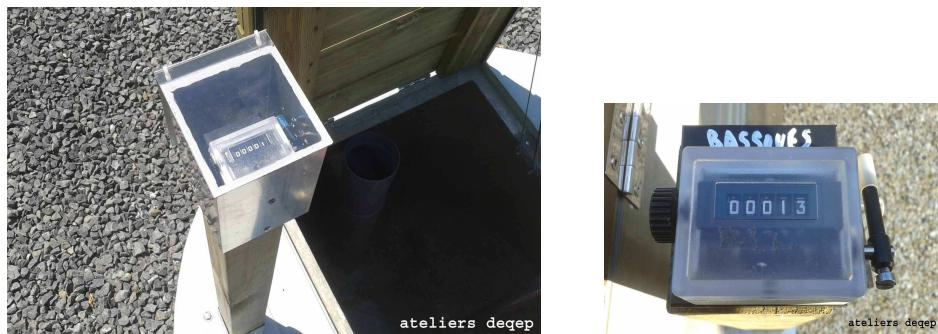
Chaque bâchée montante incrémente un compteur totalisateur mécanique inoxydable et étanche à 5 digits (rouleaux chiffrés) facilement accessible. Remise à zéro manuelle possible.
