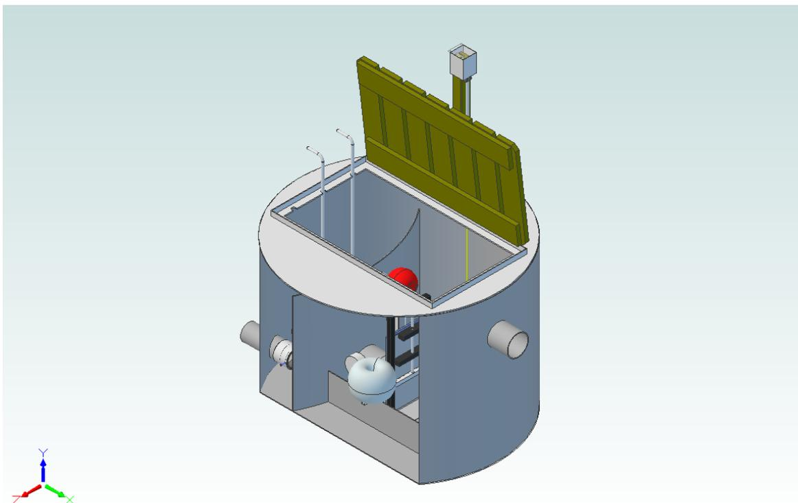
Cuve cylindrique en PRV gelcoatée gris, cloisonnée , équipée de notre mobile de chasse , Delta f-
