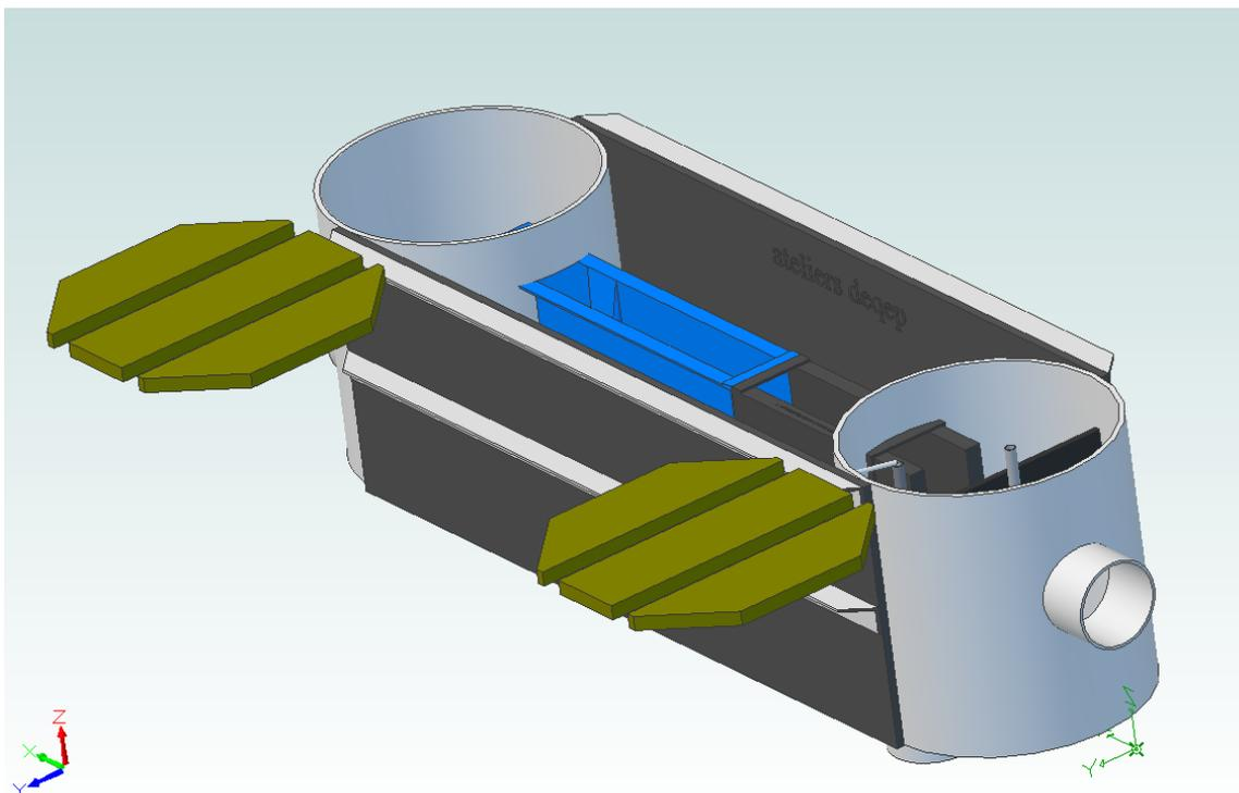
Venturi ISMA1 0,22 à 22m<sup>3</sup>/h : Ht500 X Lg 1900 X lg 500, Béton de remplissage à prévoir: 0,18m<sup>3</sup> ;
